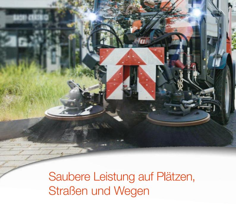
Als professionelle Kehrmaschine mit 2- oder 3-Besen-Komfortkehrsystem überzeugt der Citymaster 1650 nicht nur mit perfekten Reinigungsergebnissen: Das patentierte Umlaufwassersystem sorgt für eine maximale Staubbindung und damit für saubere Abluft und geringste Partikel- und Feinstaubemissionen. Ein klarer Vorteil für die Gesundheit des Anwenders und das direkte Einsatzumfeld.
